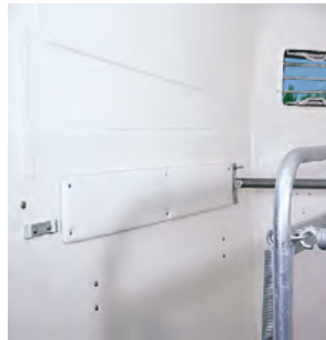
Geteilte, gepolsterte Heckstangen abhängbar und längs- verstellbar (kein Klappern während der Fahrt).
