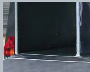
Schmutzschleusen- Gummi über Klappenscharnier- system und speziellem „High-Grip“-Belag.
