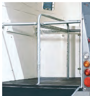
Robuste PVC-Mitteltrennwand 2-fach gesichert, schwenk- bar und herausnehmbar.
