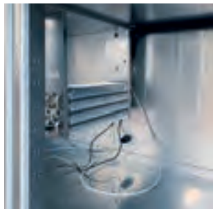
Verdampfer aus Edelstahl (Produktionsansicht)
